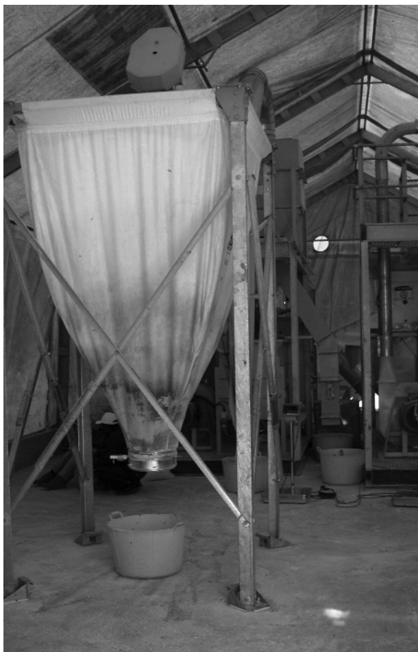
La unidad de molturación en Nangweshi (Zambia), instalada en una tienda de campaña destinada al almacenamiento.
